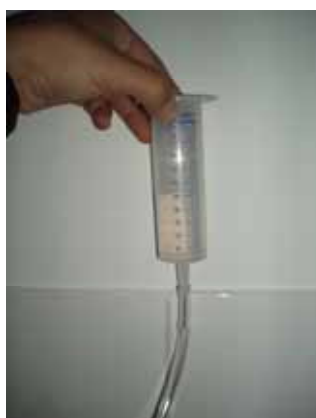
Figure 5: Retirez le piston de la seringue et la remplir de 50 ml d'eau.
